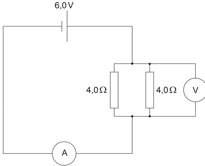
El amperímetro tiene resistencia igual a 1,0Ω y el voltímetro es ideal. ¿Cuáles serán las lecturas del amperímetro y del voltímetro?
